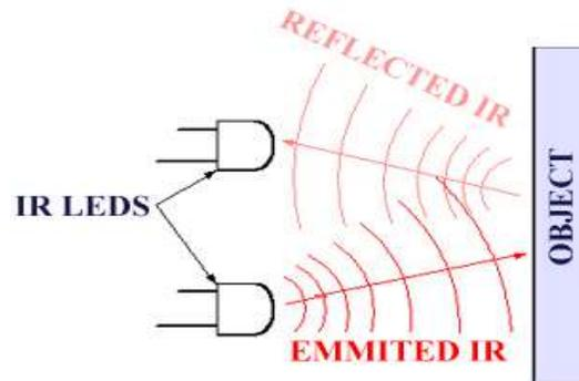
Fig. 3. Obstacle Sensor
